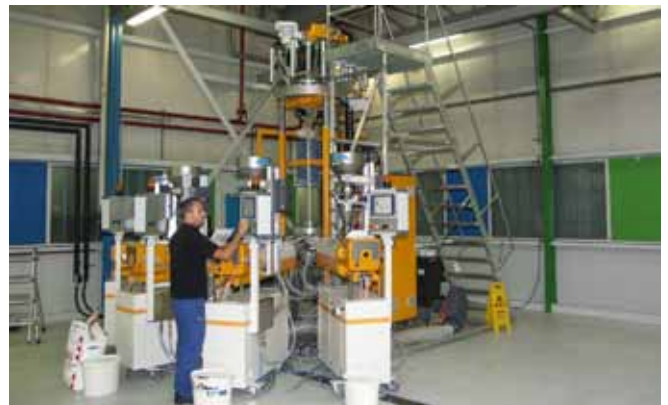
L'installation pilote commandée par ordinateur permet de fabriquer des films adhésifs de très haute qualité à l'échelle du laboratoire.
