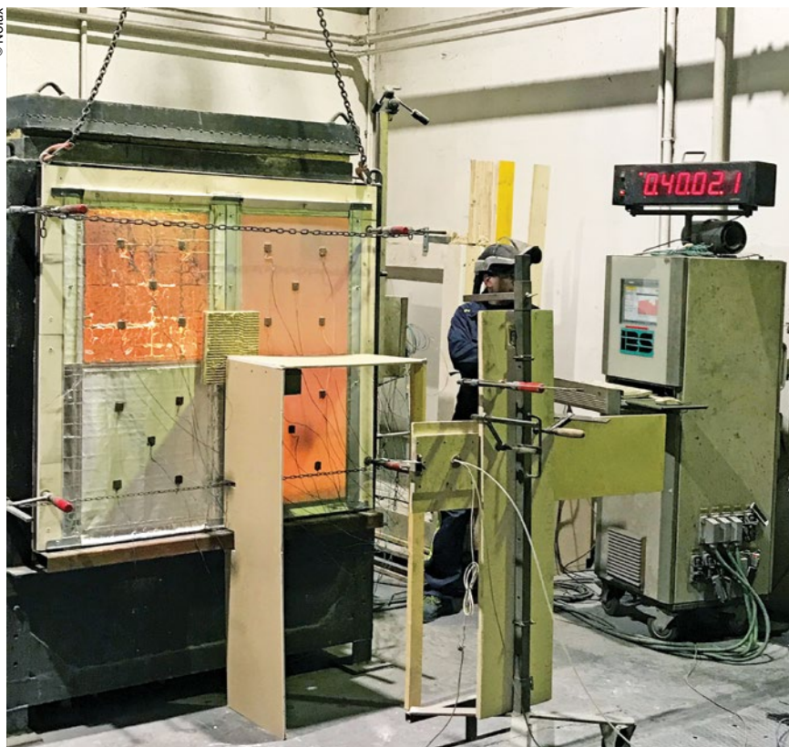
Bild 8 > Brandtest in Anlehnung an EN 1634-2019 am IBS Linz
