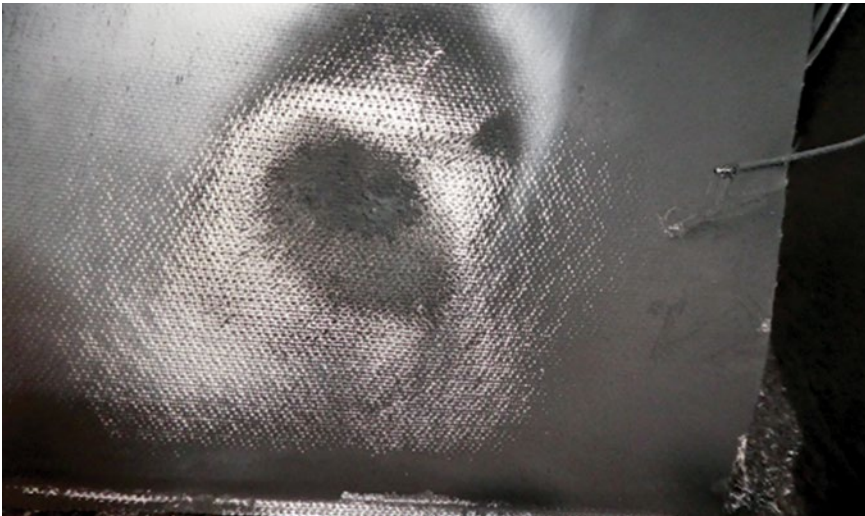
Bild 5 > Impact-Test am ZSW Ulm: Prüfkörper aus Glasfasergewebe in Kombination mit reflektierender und isolierender Nolax/Heares-Beschichtung – verklebt auf Aluminiumblech; die Impact-Seite weist weder ein Loch noch ein Durchbrennen auf.
