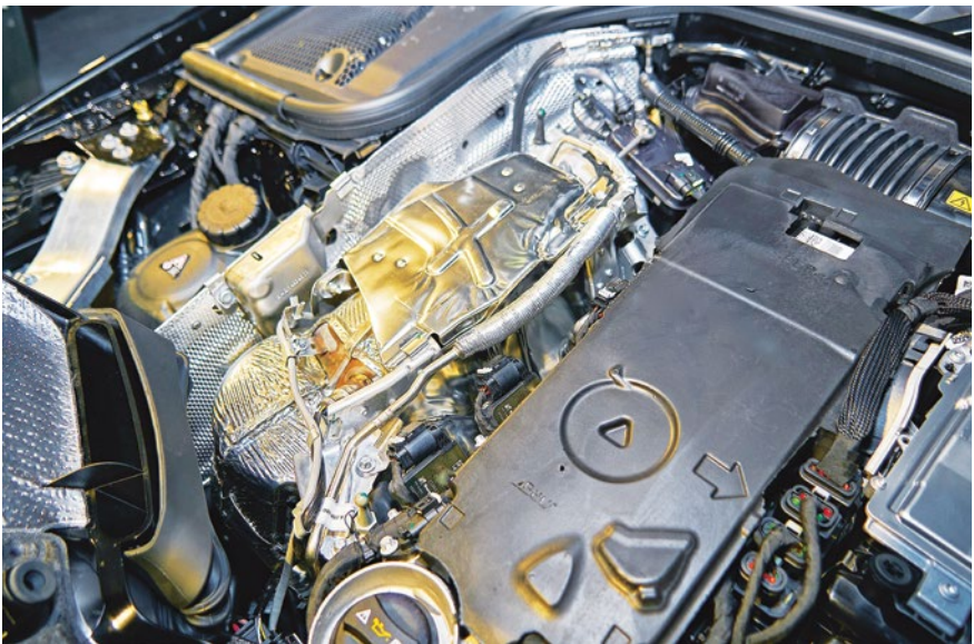
Bild 3 > Turbolader-Abdeckung in einem Verbrennungsmotor
