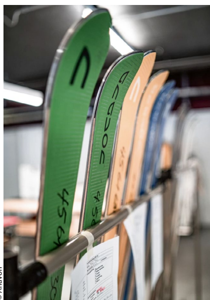
Bild 1 > Ein typischer Ski: Ein Multimateriallaminat aus Holz, Aluminium, Stahl und Polymeren.
