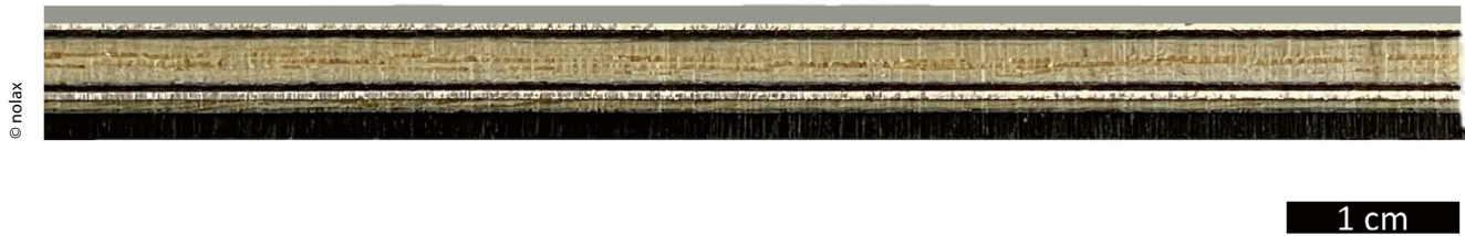
Bild 4 > Seitenansicht des Multimateriallaminats ML-1. Materialien von oben nach unten: Deckblatt aus Copolyamid, Aluminiumobergurt, Neoprengummi, Eschenkern, Neoprengummi, Aluminiumuntergurt, Eschenschnittfurnier, Laufflächen aus ultrahochmolekularem Polyethylen
