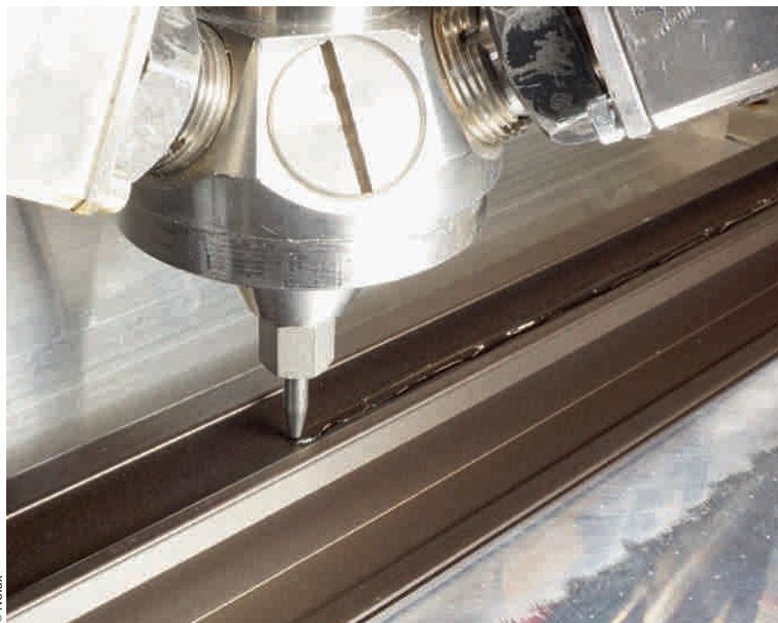
Bild 5 > Automatisierter Raupenauftrag mit schneller Aushärtung bei Raumtemperatur
