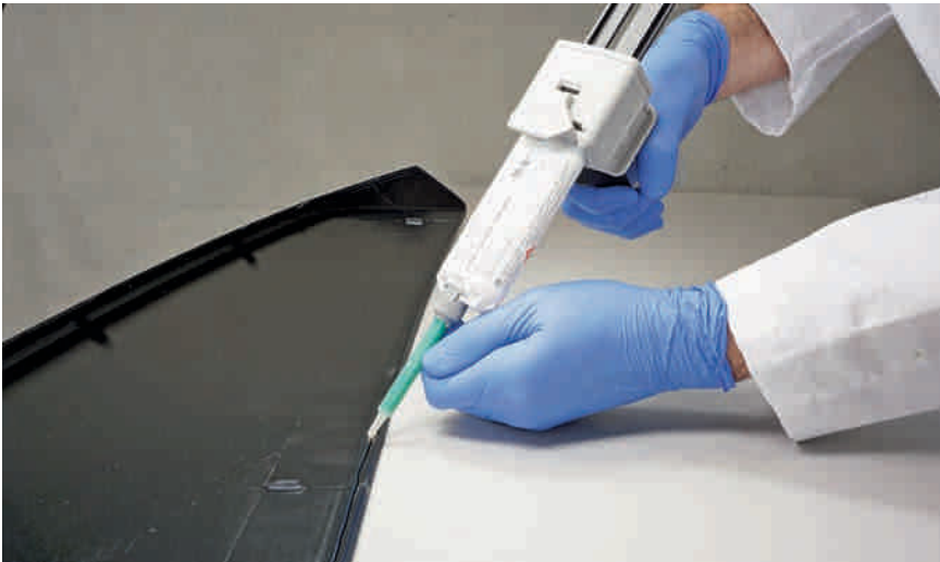
Bild 3 > Polyurea-Kartuschenklebstoff für die Montage von Exterieur-Bauteilen
