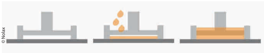
Bild 2 > Der offene Verguss ermöglicht eine schnelle Verklebung verschiedener Befestigungselemente an 3D-Bauteile
