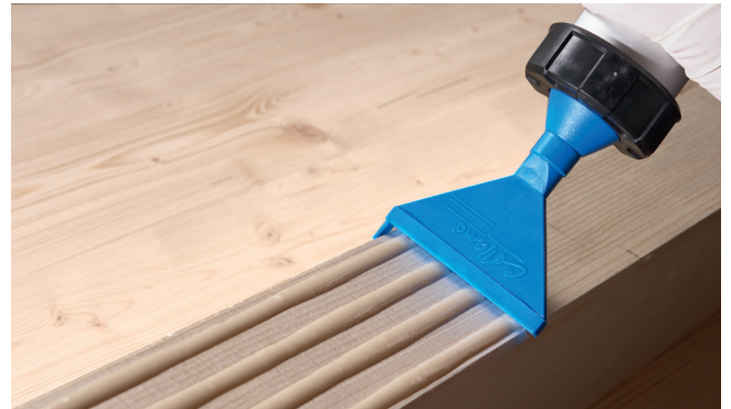
Le dosage optimale positionné correctement, garantissant le collage.
